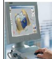
Kein Abdruck, sondern eine 3D-Kamera nimmt Ihren Zahn auf. Im Computer wird die Füllung oder Krone hochpräzise konstruiert.
